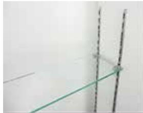
壁面にナローサポートをビス止めし、ダボ金具4ヶでガラスを支持します。ダボ柱を壁面に埋め込んで使用することもできます。金具は自由に位置を変えたり、複数枚のガラス棚を追加設置できます。
