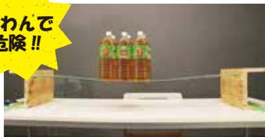
ダボタイプのように4点で支持するガラス棚の耐荷重はサイズや厚みによって異なりますが、安全に使用していただくために、コダマガラスではガラスの厚みと最大幅寸法の目安を定めておりますので、検討中の方は是非ご参考にしてください。
