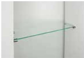
壁面に穴をあけてメンダボを埋め込み、オンダボを取付けてガラスを支持します。あらかじめメンダボを一定間隔に埋め込んでおけば、可動式の棚として使用できます。オンダボはクロームとゴールドメッキの2色があります。
